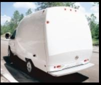
L'Aérocell SRW se situe entre le cargo van et le fourgon cube. Un nouveau concept de fourgon conçu exclusivement pour le châssis Ford E-350 tronqué · roues arrières simples. Il offre les mêmes avantages que l'Aérocell d'origine avec une construction monopièce en fibre de verre, sans joints, avec fini "gelcoat" blanc brillant et ses formes stylisées aérodynamiques.
